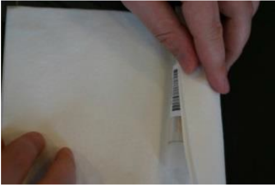
Afbeelding 2: het busje wordt voorzien van absorptiemateriaal
