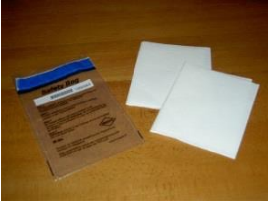
Afbeelding 1: Sealbag (links) en absorberend materiaal (rechts)
